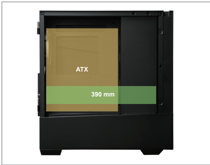
最高支援ATX主機板安裝與390mm之顯卡
